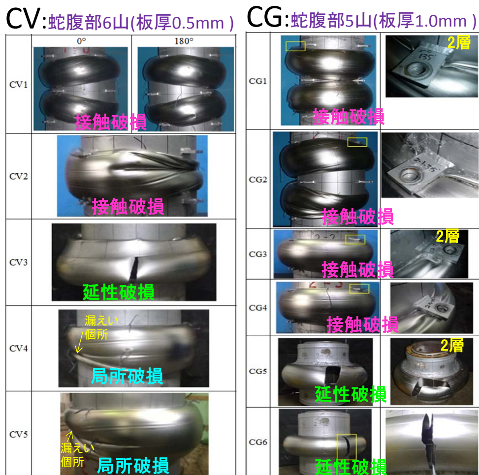
図1 ベローズ式伸縮管継手の内圧破損試験結果
